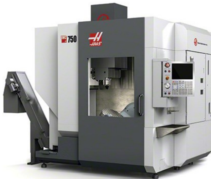
Рисунок 11 – Вертикально-фрезерный пятикоординатный обрабатывающий центр с ЧПУ Haas UMC-750
