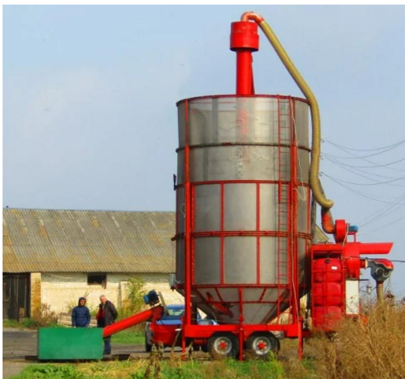
Рисунок 2.10 Зерносушилка передвижная, торговая марка "АТМ", модель АТМ-34
